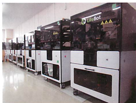
図1 SS Dnaform 横浜鶴見衛生検査所 全自動核酸抽出機 LifeBot で検査を行っている。
